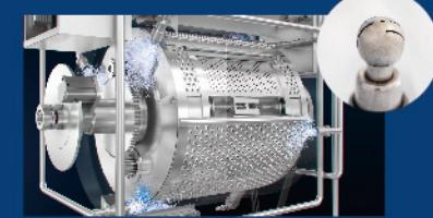
转笼内部全部满焊后机械、电解抛光双重处理,无藏污纳垢的缝隙,完全避免缝隙中的污垢对衣物的二次污染。
